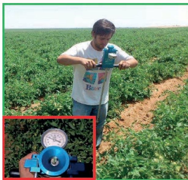
Imagen 2. Cámara de presión Pump-up (PMS Instrument Co)
