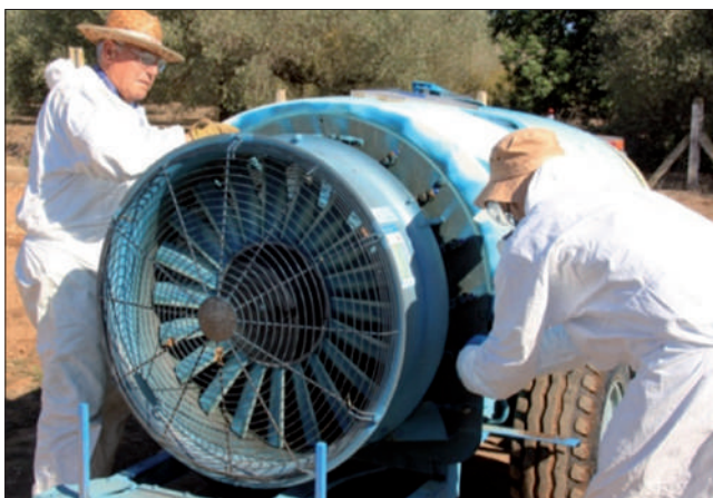
Figura 10. Revisión del equipo, previa al tratamiento: orientación de las boquillas (Planas; Tortosa, agosto 2014).
