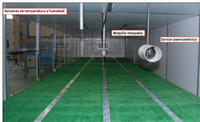
Figura 3. Vista frontal del túnel de viento. En primer plano se sitúan la boquilla ensayada y los sensores para controlar las condiciones de ensayo. A continuación, en un plano vertical, los hilos para recolectar las gotas desplazadas por el viento (deriva aérea). Más allá, no visibles, se ubican los colectores para detectar la deriva sedimentada (Torrent; Lleida, enero 2013).
