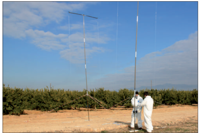
Figura 5. Toma de muestras de los colectores en el ensayo de medición de deriva (Planas; Roquetes, diciembre 2013).
