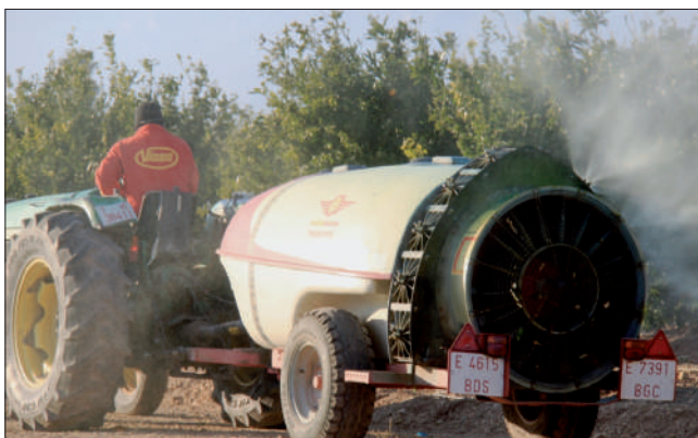
Figura 6. Pulverizador empleado en el ensayo de deriva, tratando la fila extrema de la plantación (Planas, Roquetes, diciembre 2013).
