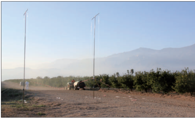
Figura 4. Ensayo de campo de deriva. Se observan los hilos de nylon sujetos a los mástiles para la medida de la deriva aérea, los colectores horizontales para la medida de deriva sedimentada y el pulverizador tratando la fila extrema (Planas; Roquetes, diciembre 2013).
