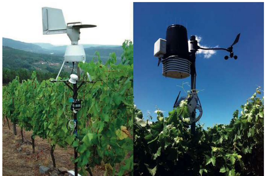
Imagen 1. Captador de esporas y estación meteorológica, respectivamente, ubicados en una de las parcelas experimentales del proyecto VITICAST. (Fuente: Instituto Geográfico Nacional).
