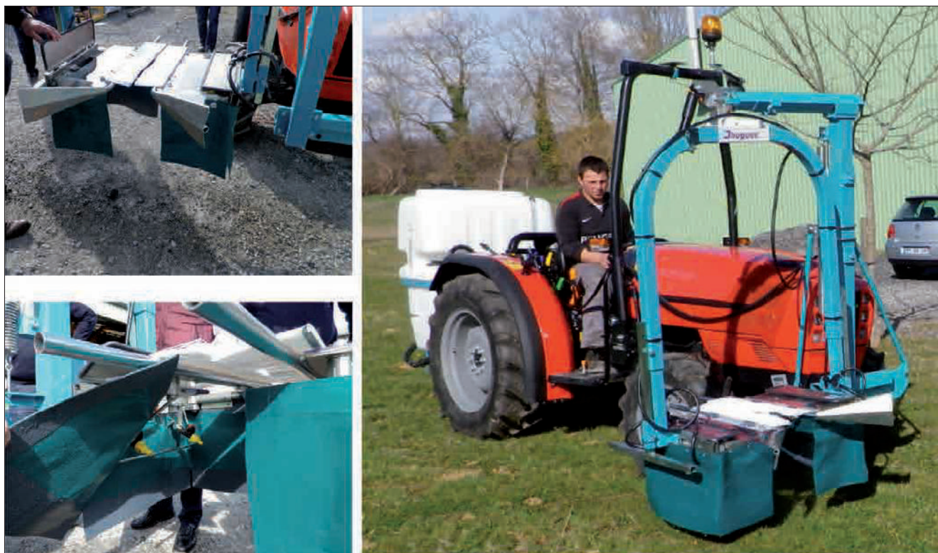
Figura 3. Detalles de la maquinaria recomendada para el control de rebrotes en viña, provista de protectores por la partes delantera y trasera, así como por la parte superior.
