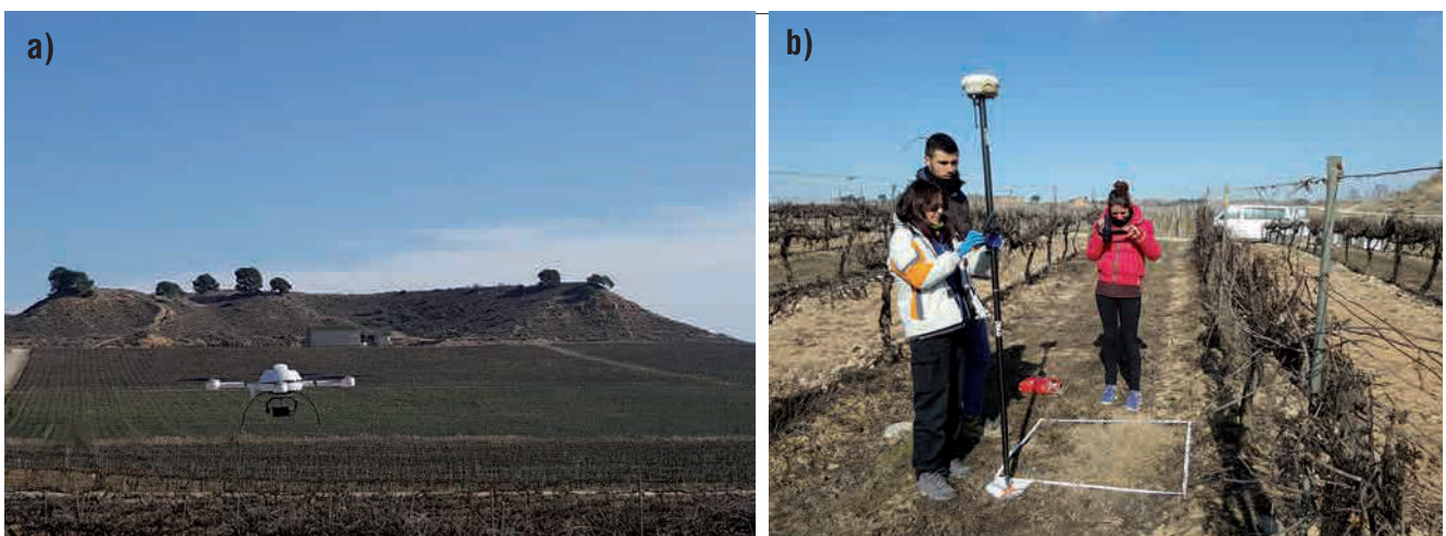
Figura 2: a) Drone modelo md4-1000 durante el vuelo; b) muestreos de campo: georreferenciación (con DGPS) de grama (parada vegetativa) en cuadrados de 1x1 m en uno de los viñedos. En esta parcela la cubierta entre calles aún no había emergido.
