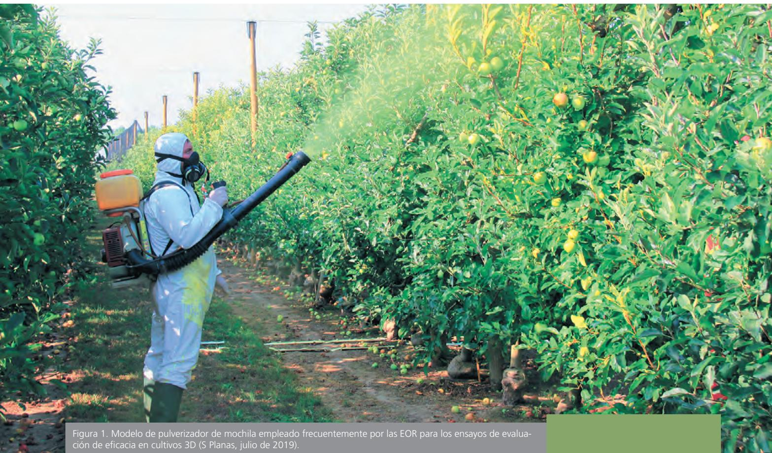
Figura 1. Modelo de pulverizador de mochila empleado frecuentemente por las EOR para los ensayos de evaluación de eficacia en cultivos 3D (S Planas, julio de 2019).
