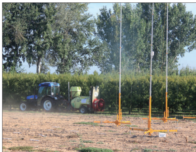
Figura 2. Monitorización de parámetros meteorológicos y del potencial contaminante (deriva) en el tratamiento de plantaciones intensivas de nectarino en Gimennells, Lleida (S. PLANAS, 2011).
