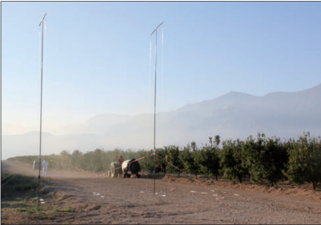
Figura 2. Ensayo de campo de deriva. Se observan los hilos de nylon sujetos a los mástiles para la medida de la deriva aérea, los colectores horizontales para la medida de deriva sedimentada y el pulverizador tratando la fila extrema (Planas; Roquetes, diciembre 2013).
