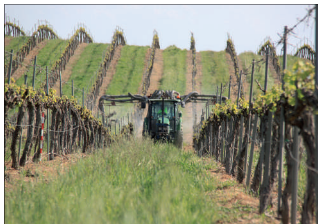
Figura 3. Tratamiento a inicio de campaña mediante un pulverizador de bocas. Para limitar las pérdidas de producto se han seleccionado y orientado las bocas operativas atendiendo a la posición de la zona objetivo.
