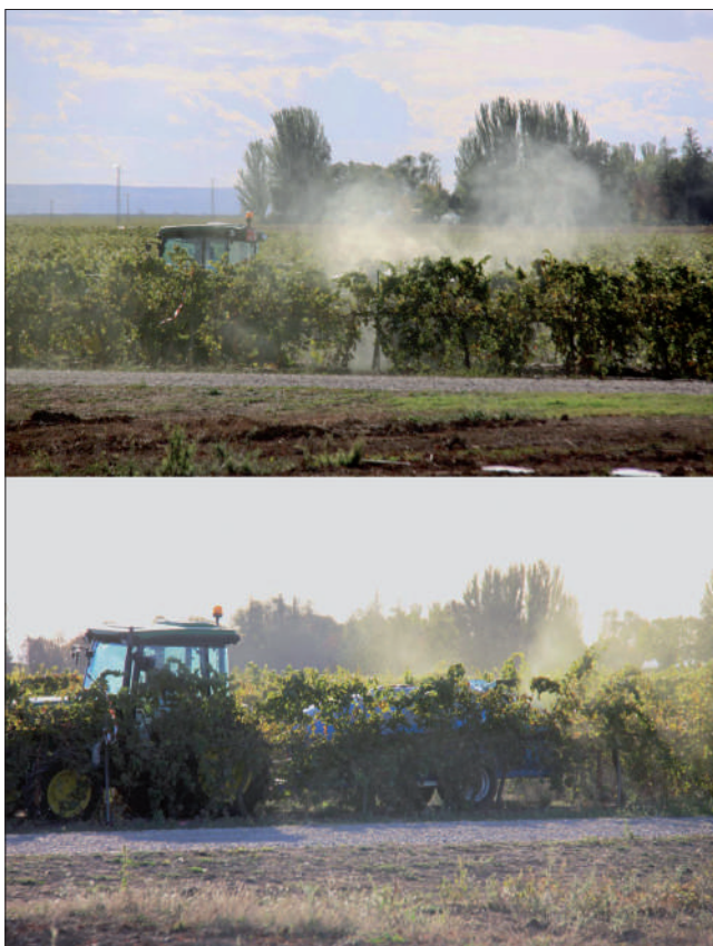
Foto 2. Tratamiento con boquillas convencionales (arriba) y tratamiento con boquillas de baja deriva (abajo). Las imágenes difieren pocos minutos, los requeridos para realizar el cambio de boquillas. Raïmat (S. Planas, 2015).
