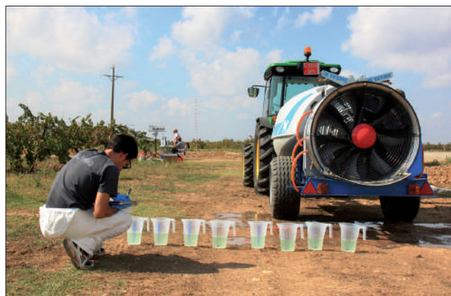
Figura 6. Medida del flujo de las boquillas mediante recipientes graduados de un pulverizador TEYME EOLO Star 2090. Lleida (Planas, 2015).
