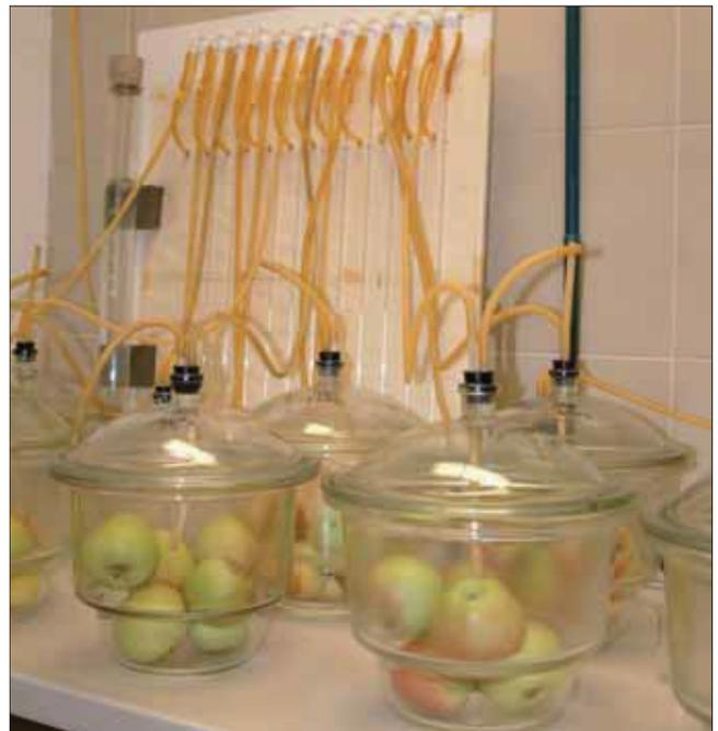
Figura 1. Sistema de medida de la producción de etileno en manzanas mediante flujo continuo de aire.
