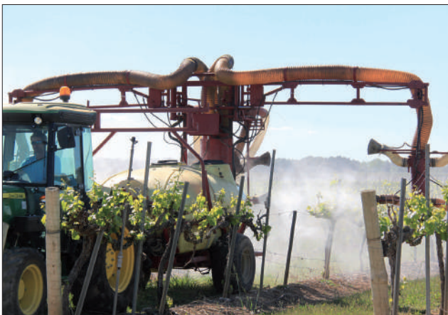
Figura 1. Pulverizador de bocas adaptables a la estructura del cultivo. Viñedos de Raïmat – DO Costers del Segre (abril de 2015).
