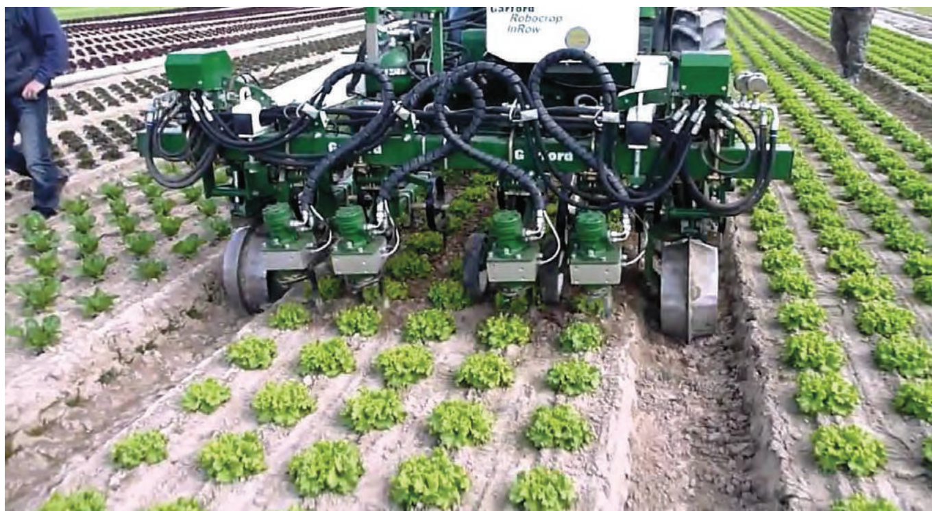
Figura 2. Robocrop InRow (Garford) realizando un control mecánico de las malas hierbas en un campo de lechugas (César Fernández-Quintanilla).
