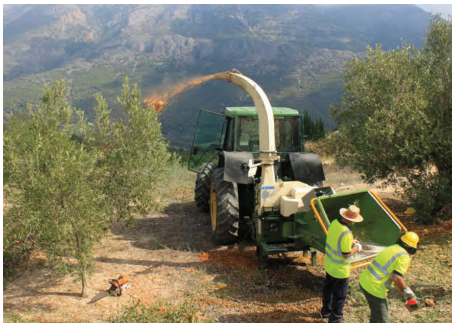
Foto 2. Astilladora de discos arrastrada para el triturado in situ .
