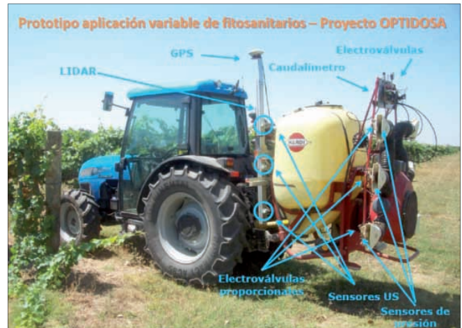
Figura 7. Prototipo de aplicación variable de producto en viña. Grupo de Maquinaria Agrícola de la UPC. Tractor cedido por AgriArgo Ibérica, S.A.
